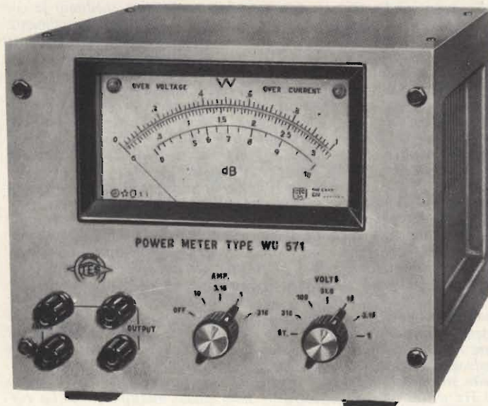
Fig. 5 - Aspetto esterno del misuratore di potenza WU 571 di cui, nelle figure precedenti, è illustrato lo schema elettrico.
